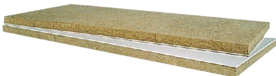
Labelrock est un complexe de doublage isolé en laine de roche double densité destiné à l'isolation de tous types de parois verticales maçonnées. Il est mis en œuvre par collage sur la paroi ou par vissage sur une ossature selon l'avis technique du procédé.
